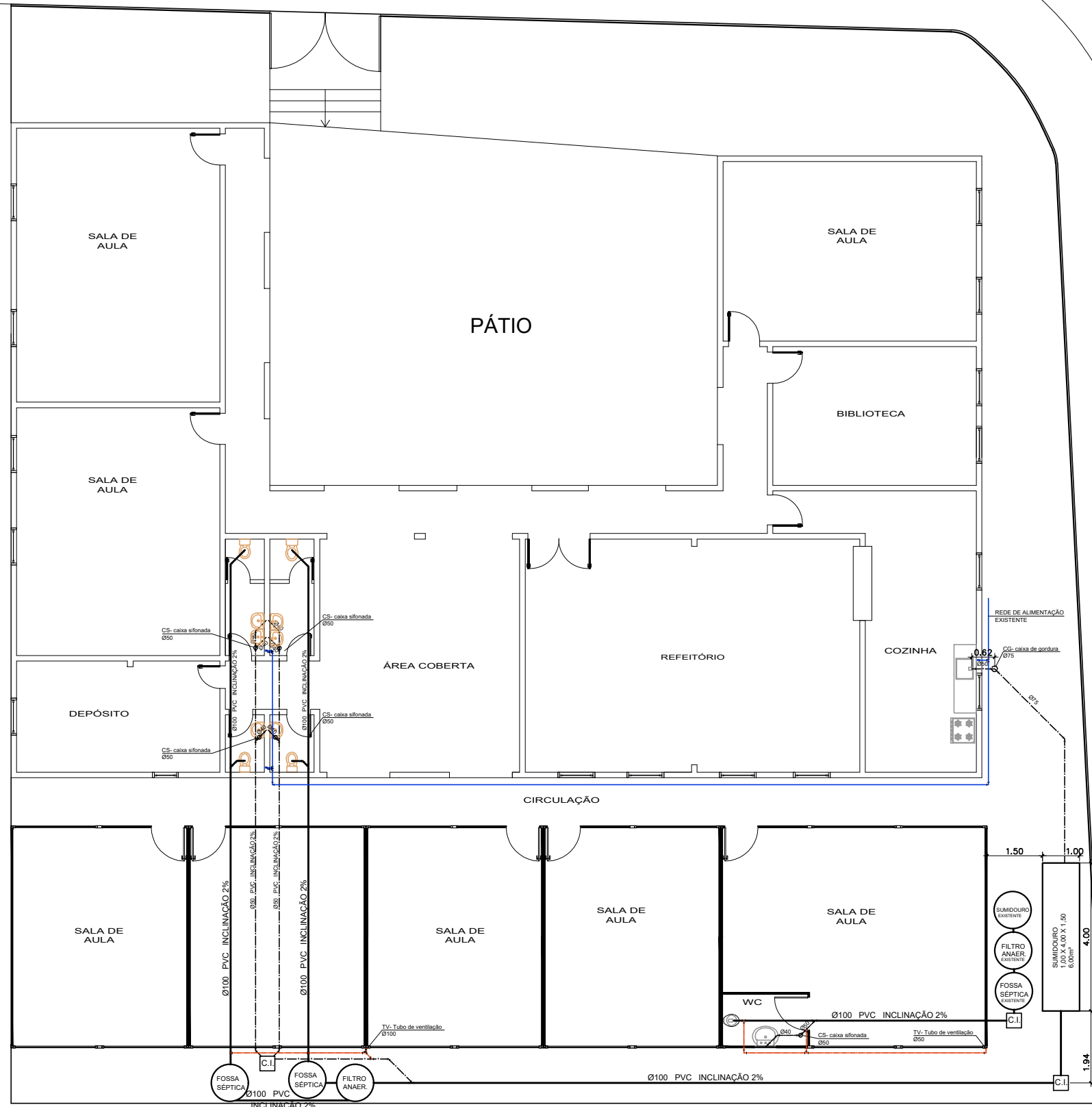
PLANTA BAIXA- ESGOTO SEM ESCALA
