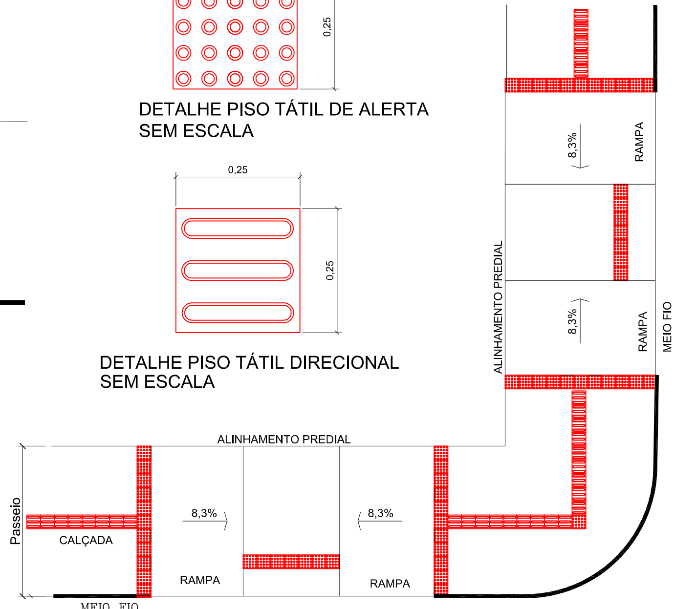
DETALHE DAS ESQUINAS SEM ESCALA
