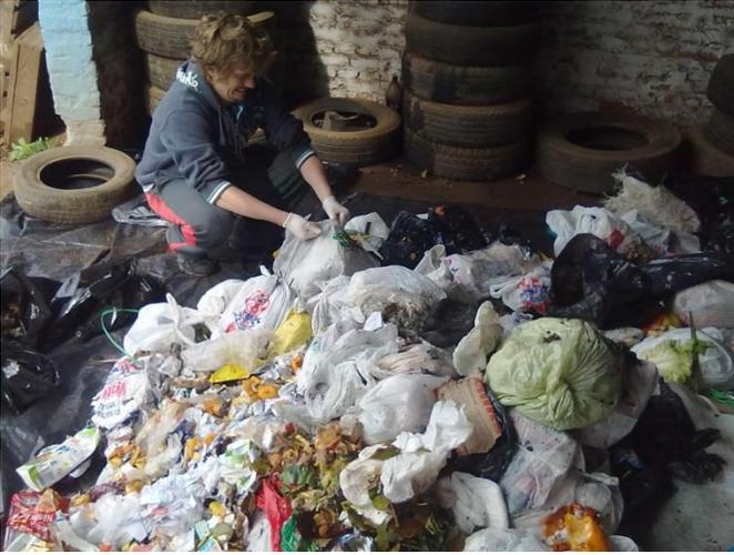
Figura AM1 - A avaliação gravimétrica do resíduo sólido doméstico envolveu no trabalho de “garimpagem do lixo”, Engenheiros, Biólogos e Estudantes. Foram segregados os componentes de 203,185 Kg de resíduos amostrais coletados, aleatoriamente, em todos os bairros e centro da cidade.
